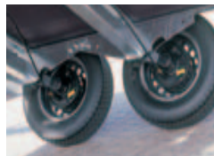
Assen van alle geremde wagens zijn uitgerust met extra grote aspadden
